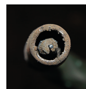
Rezultat: HeBoCoat® SL-E 125 zapobiega odkładaniu się osadów w dyszy spawalniczej i blokowaniu podawania drutu
