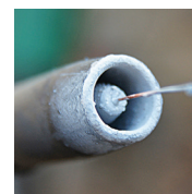
Dysza spawalnicza z nałożoną powłoką HeBoCoat® SL-E 125
