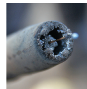
Dysza spawalnicza bez powłoki HeBoCoat® SL-E 125
